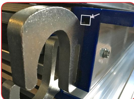
Tutti i vecchi impalcanti standard sono da oggi comunque prodotti con un nuovo tappo dotato di foro di scarico per la sabbia, il cemento e tutti i materiali che si possono infiltrare nello snodo della botola. E' sufficiente mettere la piattaforma in verticale con il foro di scarico verso il basso e battere con un martello sul piano facendo uscire il materiale.
