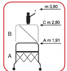
**NORMATIVE E COLLAUDI:** Aladin e Baby sono costruiti in conformità al D.LGS81/2008 per l'utilizzo nei luoghi di lavoro. I trabattelli sono stati sottoposti a test interni fra i quali test di portata e di ribaltamento, documentati e certificati per poterne dichiarare la conformità al D.Lgs.81/2008 come indicato dalla guida tecnica INAIL del 2022. La portata di Kg 110 è stata collaudata positivamente. Leggere il manuale per tutte le indicazioni di sicurezza.
