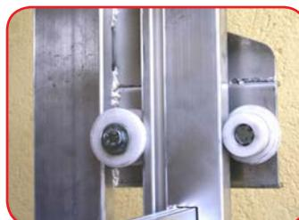
Cilindri di scorrimento in teflon
