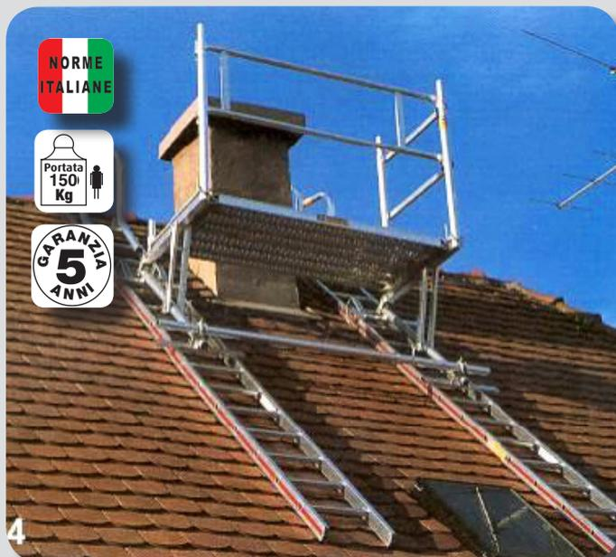
E' anche possibile usare un sistema integrato di 2 scale con aggancio TETTO FACILE su cui fissare 2 slitte di appoggio per il trabattello TEMPO TECH. Le scale semplici forniscono una salita in tutta sicurezza fino al punto di lavoro e creano una base solida per il trabattello. Le 2 slitte sono agganciate ai pioli delle scale.
