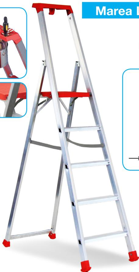
Scala doppia a gradini costruita in alluminio estruso nervato concepita per utilizzo domestico e hobbistico. Montanti rampa in profilo rettangolare mm 50x25 ergonomici nell'impugnatura. Cerniere di apertura in acciaio. Rampa ribordata con sistema a sandwich di grande tenuta. Lo schienale è rinforzato e saldato con robot di ultima generazione. Spessore chiusa cm 12
