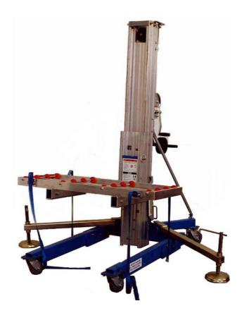
Elevatore per feretri monotrave in alluminio con base richiudibile, innalzamento manuale oliodinamico, tramite pompa a mano e catene in acciaio.
