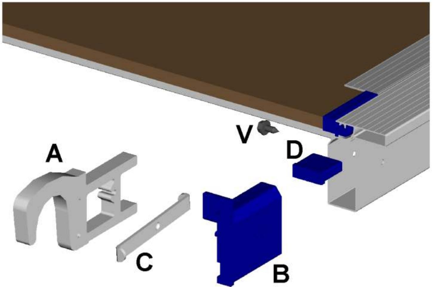
Il gancio è composto da una parte in alluminio (A), una in plastica (B) e l'antivento in acciaio zincato (C). Viene fissato con una vite (V) e rifinito con il tappo (D)
