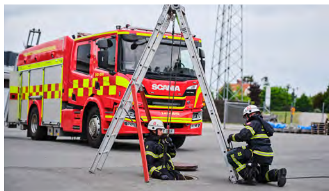
Cavalletto di salvataggio: sezione inferiore, sezione intermedia e consoli di ancoraggio.
