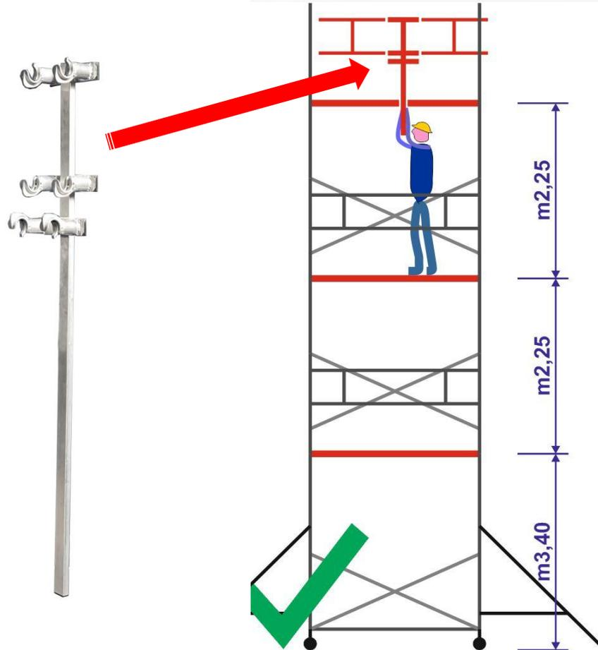
**SERVOTECH** ha sido diseñado para montar las barandillas de la plataforma inferior en los andamios **TEMPO TECH**
