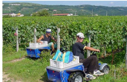
**JAY 800** representa la solución ideal para la recolección y poda de viñedos. Equipado con freno de seguridad y asiento con sensor de presencia que sólo permite poner el vehículo en marcha con un operador a bordo. Incluye baterías y cargador.
