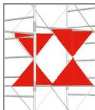
Las crucetas conforman 4 triángulos isostáticos
