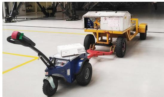
**M9** es un vehículo eléctrico de arrastre M9 facilita el transporte de cargas de hasta 3.000 kg, eliminando la manipulación manual. Dispone de ruedas neumáticas para uso en interiores y exteriores, un botón de ajuste de 5 velocidades y una variedad de enganches personalizados para adaptarse a distintas necesidades.
