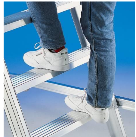
GRADINI ANTISDRUCCIOLO LARGHEZZA PEDATA 10 cm, ALTEZZA ALZATA 24 cm
