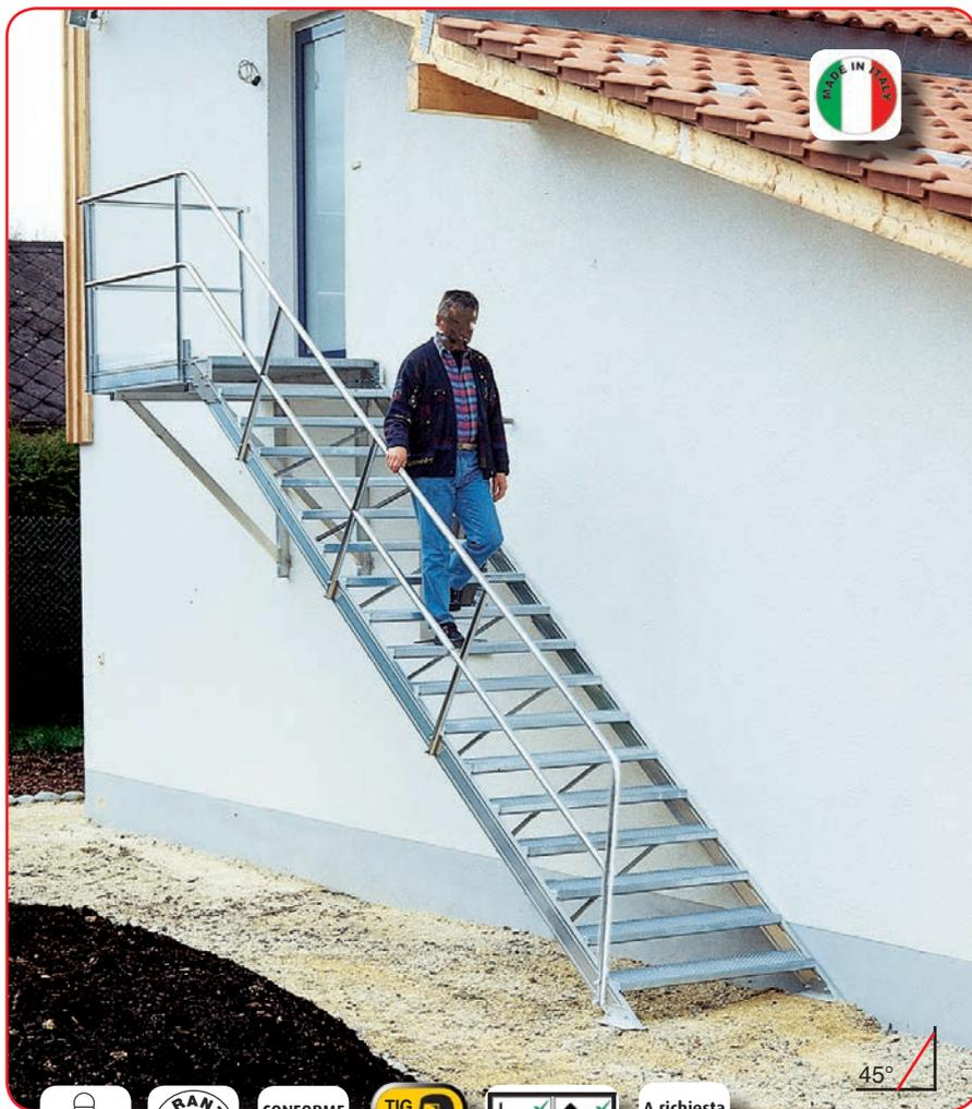
Costruite in alluminio estruso nervato con ampia piattaforma di sbarco, corrimano e paraginocchia, guardacorpo di protezione alto cm 110. La rampa di salita larga e comoda ha un'inclinazione di 45° o 60° per una salita veramente comoda garantita anche dai gradini piani antisdrucciolo profondi cm 24 e con distanza di soli centimetri 20 ca. l'uno dall'altro. Le scale sono fornite già montate e possono essere facilmente posizionate e fissate alla parete senza perdita di tempo.
