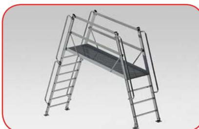
Scala professionale a ponte con luce libera sotto la piattaforma per lo scavalco di linee di produzione o il passaggio su coperture in presenza di ostacoli fissi. E' in alluminio estruso saldato a TIG e viene consegnata smontata con un ingombro di spedizione veramente ridotto. Può essere richiesta con stabilizzatori di base o con piastre preforate per il fissaggio a pavimento. Viteria di montaggio in dotazione.
