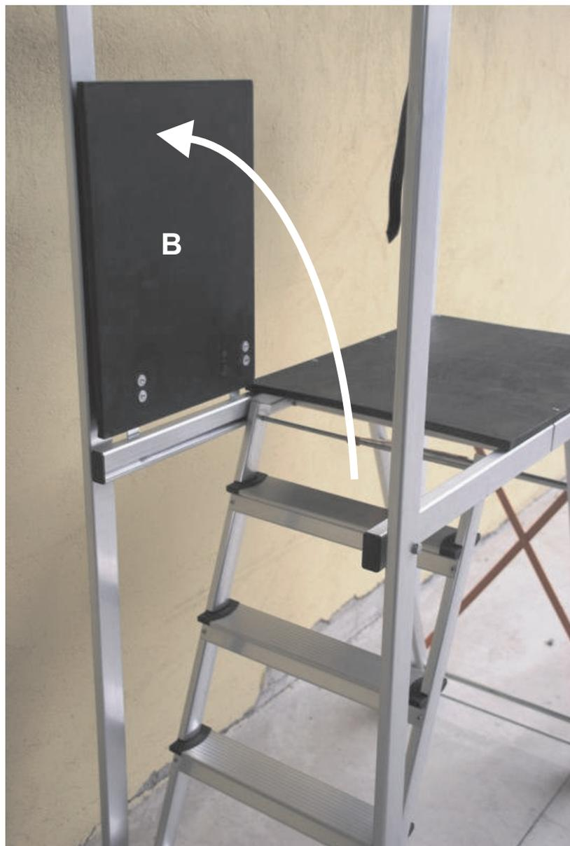
Per utilizzare correttamente l'attrezzatura è sufficiente posizionarla nel punto desiderato, aprire la botola (**B**), salire sul piano di calpestio utilizzando l'apposita scala e richiudere la botola.
