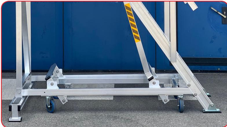
Sicurblock attivato con ruote non attive e scala saldamente appoggiata al suolo
