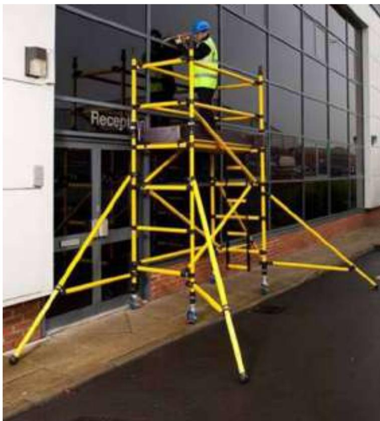
Tempo Advance es un andamio de fibra de vidrio completamente aislante y muy resistente dirigido al mercado eléctrico e industrial. Dispone de ruedas, husillos niveladores y escalera lateral vertical incorporada al andamio en los marcos de un lateral. Testado a 1000 voltios.
