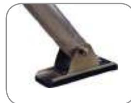
Estabilizadores equipados con zapatas basculantes
